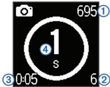
Устройство сделает серию снимков с заданным интервалом времени. На экране отображается оставшееся количество фотографий, которые могут быть сделаны устройством ①, количество сделанных фотографий ②, прошедшее время ③ и время до съемки следующей фотографии в секундах ④.
