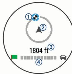
Индикатор пункта назначения ① показывает направление к пункту назначения относительно направления вашего движения ②. Если индикатор пункта назначения отображается в верхней части круга, вы двигаетесь прямо к пункту назначения. Оставшееся расстояние до пункта назначения ③ отображается под кругом. Строка выполнения ④ отражает выполнение навигации к пункту назначения.
